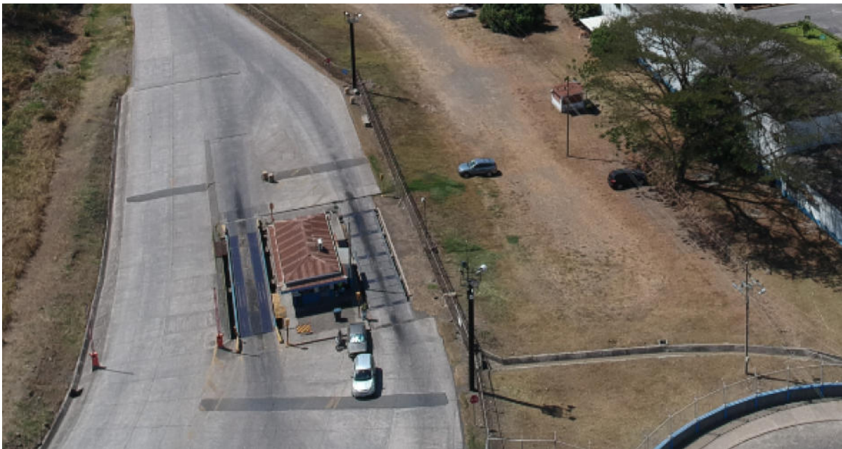
Figura 4-34 la estación de pesaje con una báscula por sentido
