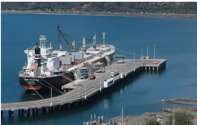
Figura 7-6 Descarga de un granelero seco con el equipo del buque en el atraque 4
